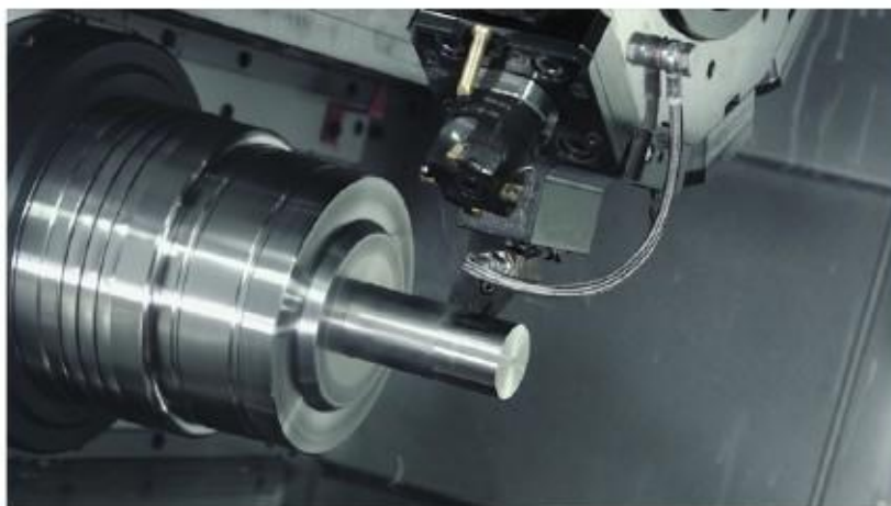
Příklad nasměrování chladicí kapaliny na destičku.
